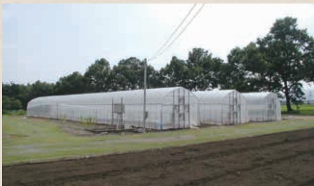
写真2 温暖化実験に用いた温度勾配チャンバー（熊本県合志市）
