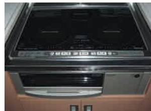
家庭科室のIHクッキングヒーター
